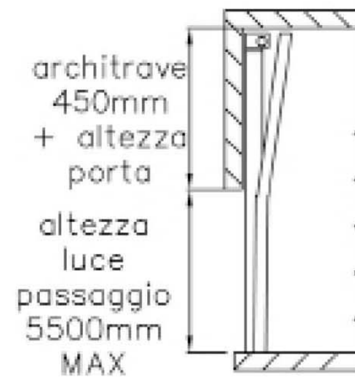
versione WL scorrimento MONOGUIDA totalmente verticale con architrave 450mm più altezza porta
