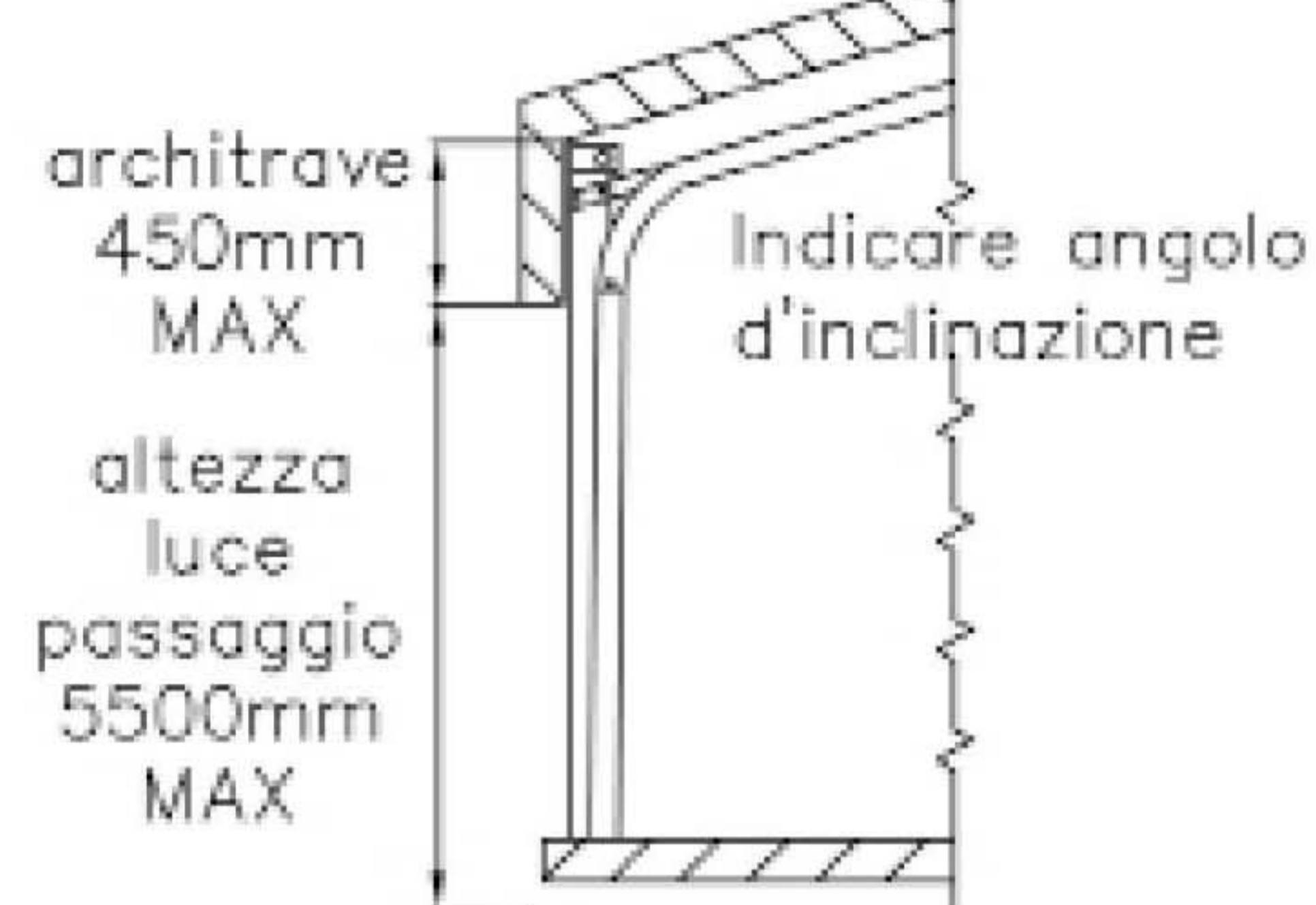
versione WH scorrimento MONOGUIDA con architrave RIALZATA da 2000mm a 3000mm
